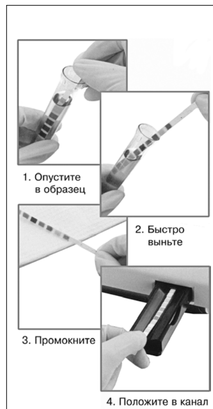
Рис. 2. Порядок использования тест-полоски UrineRS H-10 для анализатора CL-50
